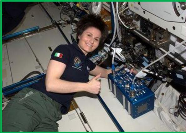
HAMTV (abreviatura de "Ham Television") es un sistema de transmisión de vídeo digital que opera en la banda de 13 cm (alrededor de 2.4 GHz), utilizando el estándar DVB-S y codificación MPEG-2. Su señal puede ser recibida por estaciones de radioaficionados equipadas con antenas direccionales y receptores adecuados, permitiendo ver a los astronautas en vídeo real durante los contactos de ARISS (Amateur Radio on the International Space Station).
